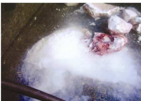
Figura 4, 5, 6. Agregar piedras de cal al otro recipiente para disolver y emitir calor y gas
