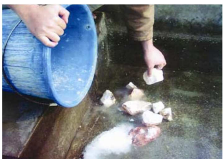
Figura 4, 5, 6. Agregar piedras de cal al otro recipiente para disolver y emitir calor y gas
