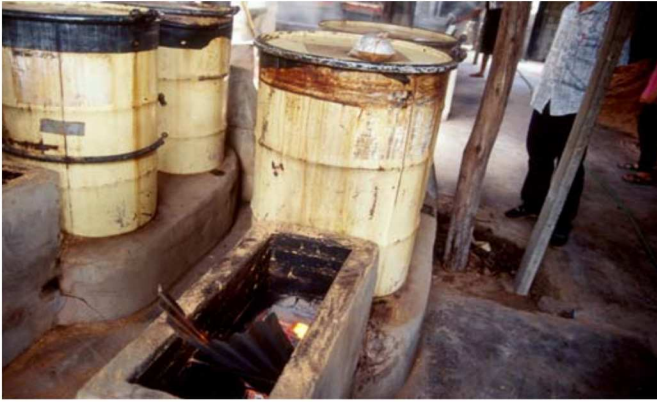
Figura 18. Esterilizador tradicional hecho con un tambor de aceite
