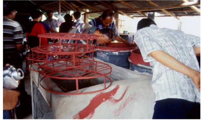
Figura 19. Reja de metal para el esterilizador (tambor de aceite)
